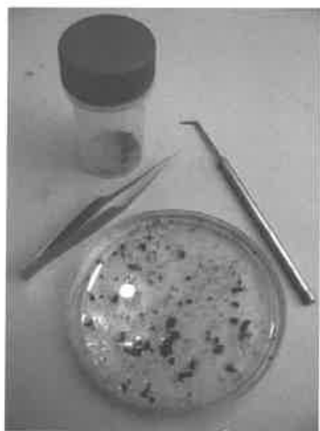
Fig 2 : préparation d'un échantillon pour son observation sous loupe binoculaire
